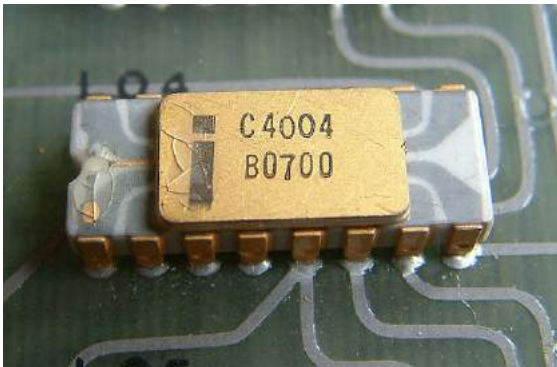
Intel 4004 (1970) boîtier DIL céramique : 20,3 × 7,6 mm
